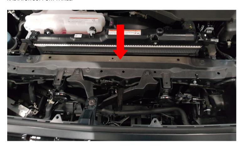
CLAMP HOSES SHOWN TO REDUCE THE LOSS OF COOLANT AND REMOVE LOWER HOSE JOINING THE INTAKE TO THE Y PIECE SHOWN.
