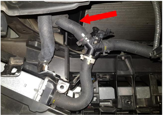
GENTLY BEND THE SUPPORT BRACKET FOR THE Y PIECE TOWARD THE FRONT OF THE VEHICLE LIKE SHOWN. SHORTEN THE LONG HOSE GOING TO THE PASSANGER SIDE HEAT EXCHANGER BY 35MM AND RE INSTALL.
