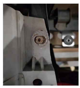
MARK POSITION OF THE BONNET LATCH MECHANISM
