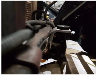
INSTALL STRAIGHT REDUCER TO TURBO AND HUMP SILICONE TO MANIFOLD. TIGHTEN HOSE CLAMP.
