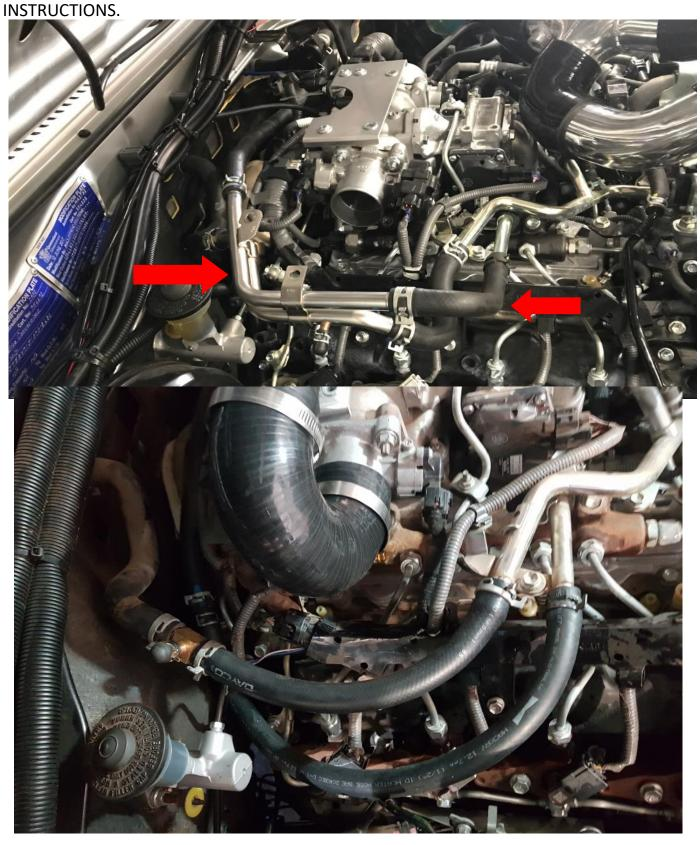
ROTATE THE SPRING CLIPS ON THE EGR COOLER LINES SO THEY ARE FACING SIDEWAYS (IF APPLICABLE.)
