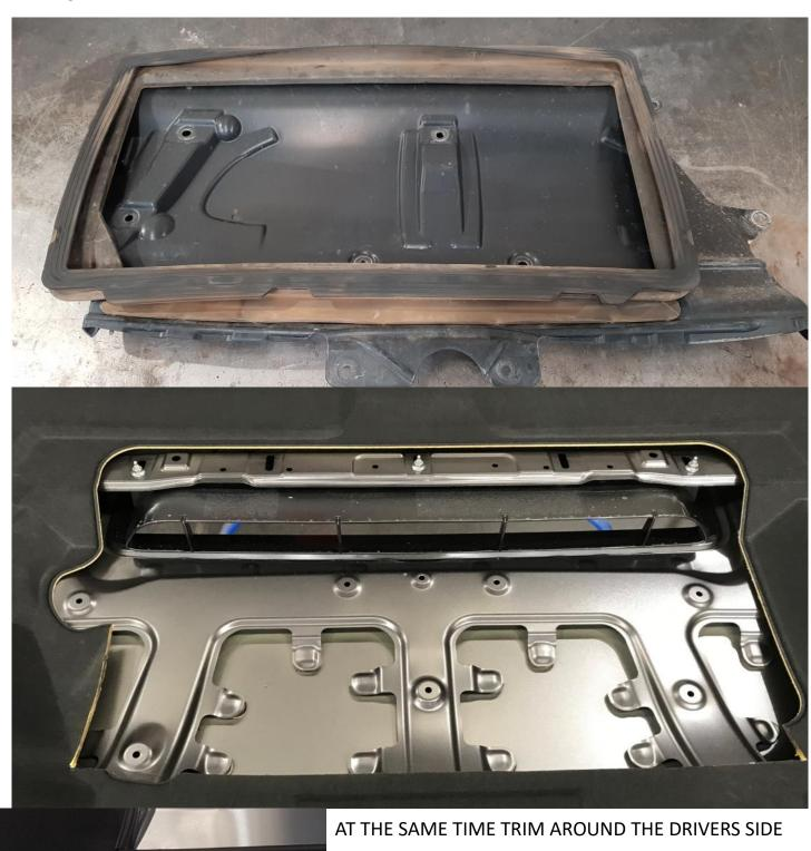
AT THE SAME TIME TRIM AROUND THE DRIVERS SIDE WASHER JET AS SHOWN AND CABLE TIE WASHER JET HOSE.
