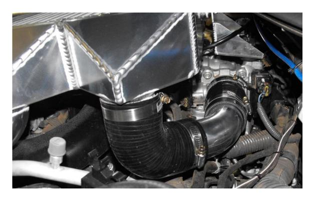
INSTALL THE 45MM 45 DEGREE SILICONE (60X85) TO THE PASSANGER SIDE TURBO PIPE. WITH LONG END TO TURBO.
