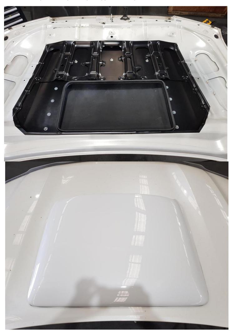
THE INSULATION CAN BE TRIMMED AND REINSTALLED AS SHOWN.
