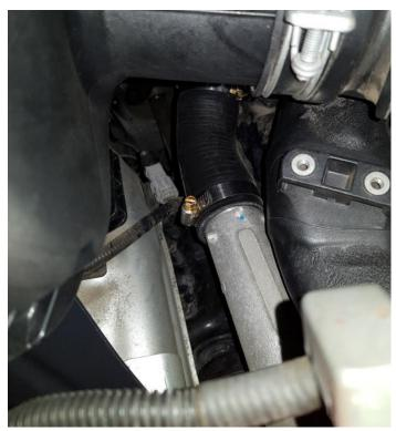
INSTALL 45MM STRAIGHT SILICONE TO END WITH HOSE CLAMPS LEAVING LOOSE. PLEASE NOTE OLD STYLE PIPE SHOWN. INSTALL INTERCOOLER WITH M8X16 BOLTS SUPPLIED PUSHING ON THE STRAIGHT SILICONE. LEAVE BOLTS FINGER TIGHT.
