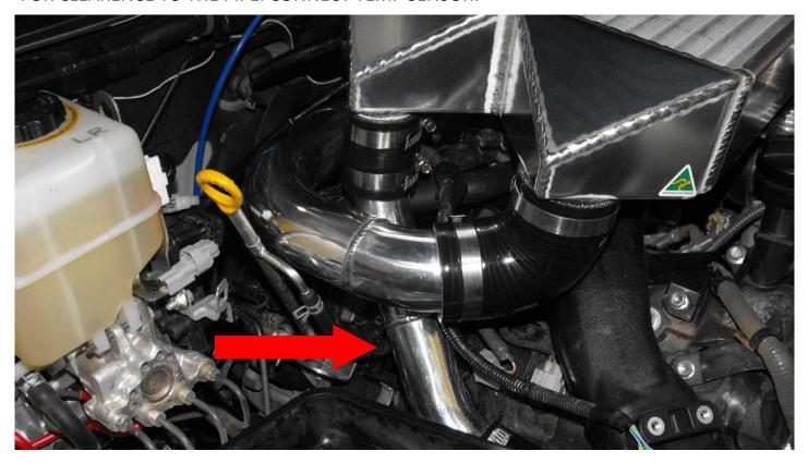
INSTALL 57MM 45 DEGREE ALUMINIUM BEND AND 57MM 90 DEGREE SILICONE (80X80) AS SHOWN.
