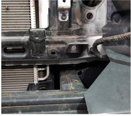
BEFORE INSTALLING THE INTERCOOLER GRIND A SMALL AMOUNT OFF THE TRANS COOLER LINE SUPPORT BRACKET, PAINT BARE METAL AND INSTALL RELOCATION BRACKET AS SHOWN.
