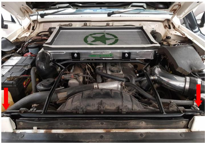
WITH INTERCOOLER INSTALLED WIRE THE FAN AS SHOWN. WE RECOMMEND RUNNING THE FAN OFF THE IGNITION CURCUIT. A GOOD PLACE FOR AN IGNITION FEED ON THE NISSAN PATROL IS THE WIPER MOTOR.
