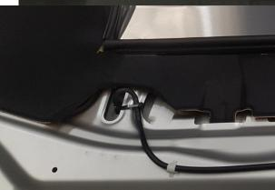
AT THE SAME TIME TRIM AROUND THE DRIVERS SIDE WASHER JET AS SHOWN AND CABLE TIE WASHER JET HOSE. WITH THE SOUND DEADENING TRIMMED INSTALL THE NEW SHROUD USING THE TRIM CLIPS SUPPLIED. THE TOP LEFT HOLE WILL NEED TO BE DRILLED TO 6.5MM. USE A DRILL STOP ON THE DRILL AS NOT TO HIT THE BONNET SKIN UNDERNEATH WHEN DRILLING.
