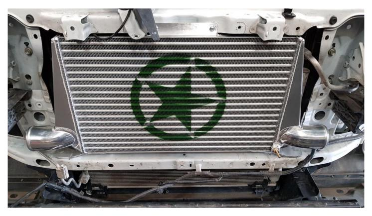
INSTALL INTERCOOLER LIFTING THE RADIATOR SUPPORT PANEL SLIGHTLY FOR EASE OF FIT-MENT. ONCE FITTED RETIGHTEN BOLTS ON THE SUPPORT PANEL
