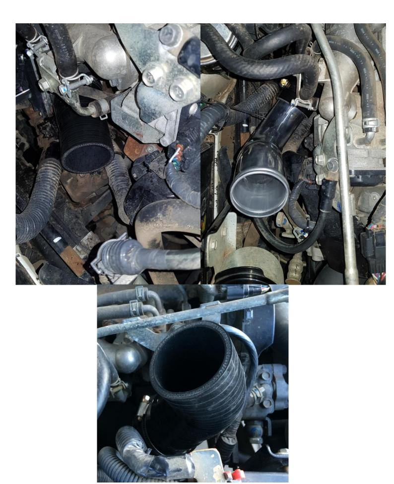
INSTALL TURBO SIDE PIPE WORK AS SHOWN INSTALLING THE 90 DEGREE SILICONE REDUC-ER TO THE TURBO FOLLOWED BY THE 45 DEGREE ALUMINIUM BEND FOLLOWED BY THE 90 DEGREE SILICONE HAVING THE SHORTEST END POINTING UP TO WHERE THE INTERCOOLER WILL BE. TIGHTEN THE HOSE CLAMP ON THE TURBO END AND LEAVE THE REST LOOSE FOR NOW.
