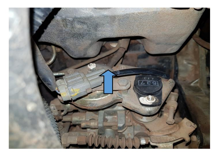
REMOVE FACTORY VACUUM HARD LINE BRACKET AND VACUUM LINE GOING TO THE FUEL PUMP FROM THE TOP OF THE INLET MANIFOLD. RUN SUPPLIED VAC HOSE FROM THE NEW INLET ADAPTOR TO THE BOOST COMPINSATOR ON TOP OF THE FUEL PUMP.
