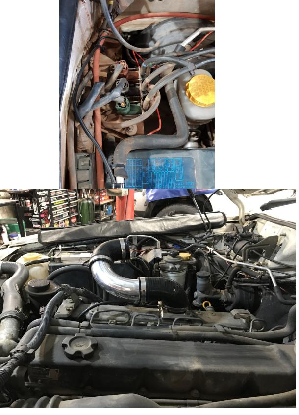
FIT THE SHORTEST CUT SILICONE WHICH IS SLIGHTLY ANGLED TO THE INLET ADAPTOR AS SHOWN MAKING SURE THAT IT IS ANGLEING DOWN SLIGHTLY. TIGHTEN HOSE CLAMP. FIT THE 90 DEGREE ALUMINIUM BEND AND 90 DEGREE SILICONE AS SHOWN FIT HOSE CLAMPS BUT DO NOT TIGHTEN YET.
