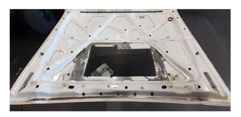
ONCE ALL CUTTING AND PAINTING IS FINISHED INSTALL THE INFILL PLATE SUPPLIED AS SHOWN. AFTER THE INFILL PLATE IS INSTALLED FIT THE BONNET SCOOP.
