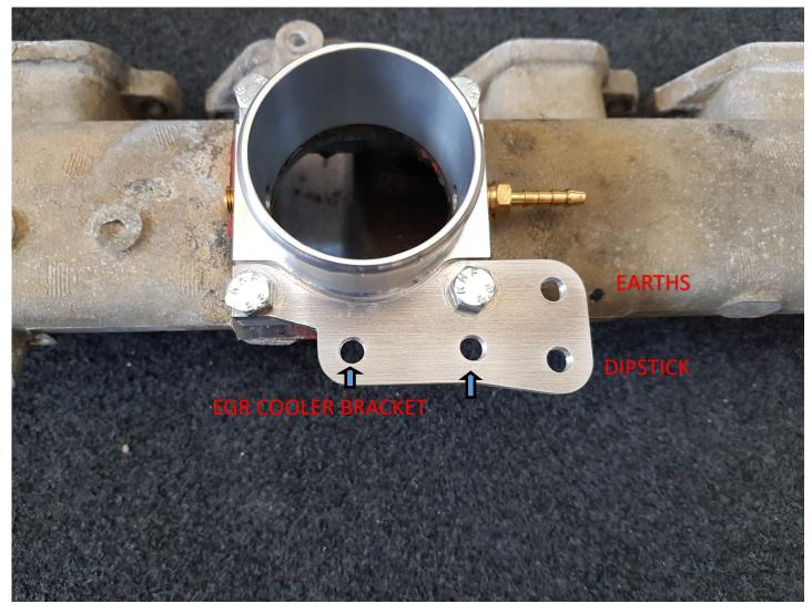
ONCE INSTALLED RE ATTACH THE EGR COOLER BRACKET DIPSTICK AND EARTH CABLES. RUN THE VACUUM LINE FROM THE INLET ADAPTOR TO THE BOOST COMENSATOR ON THE TOP OF THE FUEL PUMP.
