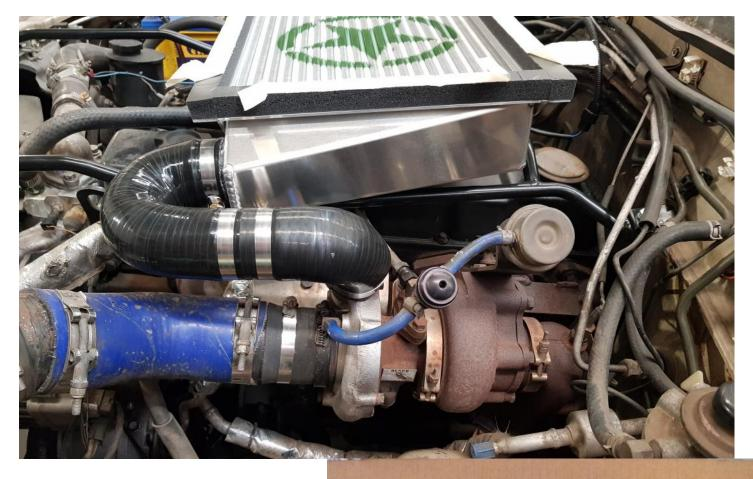
WITH INTERCOOLER INSTALLED WIRE THE FAN AS SHOWN. WE RECOMMEND RUNNING THE FAN OFF THE IGNITION CURCUIT. A GOOD PLACE FOR AN IGNITION FEED ON NISSAN PATROLS IS THE WIPER MOTOR.
