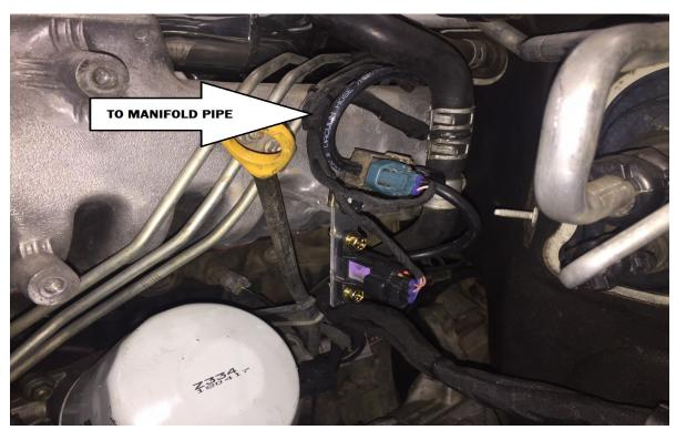
IF A 79 SERIES 1HDFTE OR EARLY 100 SERIES RUN THE LONG VACUUM HOSE SUPPLIED FROM THE SOLENOID ON THE SOFT SHUT OFF VALVE TO THE VACUUM PUMP AS SHOWN .
