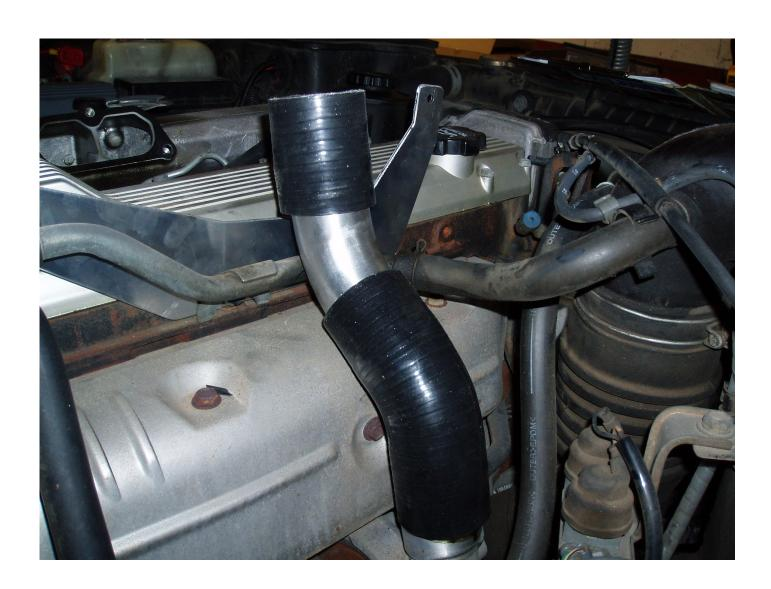
WITH INTERCOOLER FITTED. INSTALL THE WIRING LOOM AS SHOWN. A GOOD PLACE FOR IGNITION IS THE WIPER MOTOR OR THE BREAK OUT BOX DEPENDING ON MODEL.
