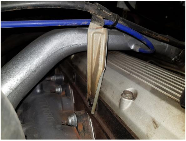
INSTALL INLET ADAPTOR USING SILICONE SEALANT AND RE ATTACH THROTTLE CABLE BRACKET. INSTALL SILICONES AS SHOWN. THE SILICONES WILL NEED TO BE TRIMMED TO ALLOW CLEARENCE TO THE HEATER TAP. LEAVE ASSEMBLED AS SHOWN UNTIL THE INTERCOOLER IS INSTALLED AND THEN TRIM AND INSTALL THE LAST SILICONE
