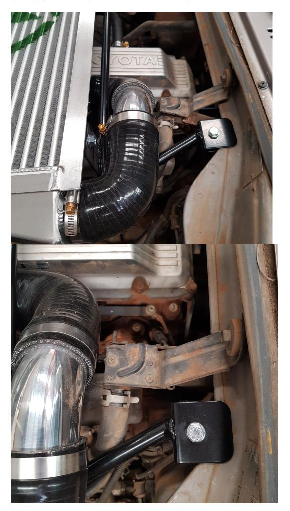
WITH THE INTERCOOLER FITTED TRIM THE 2 SILICONES ON THE TURBO SIDE TO FIT, ONCE CUT ASSEMBLE WITH ALLUMINIUM JOINER
