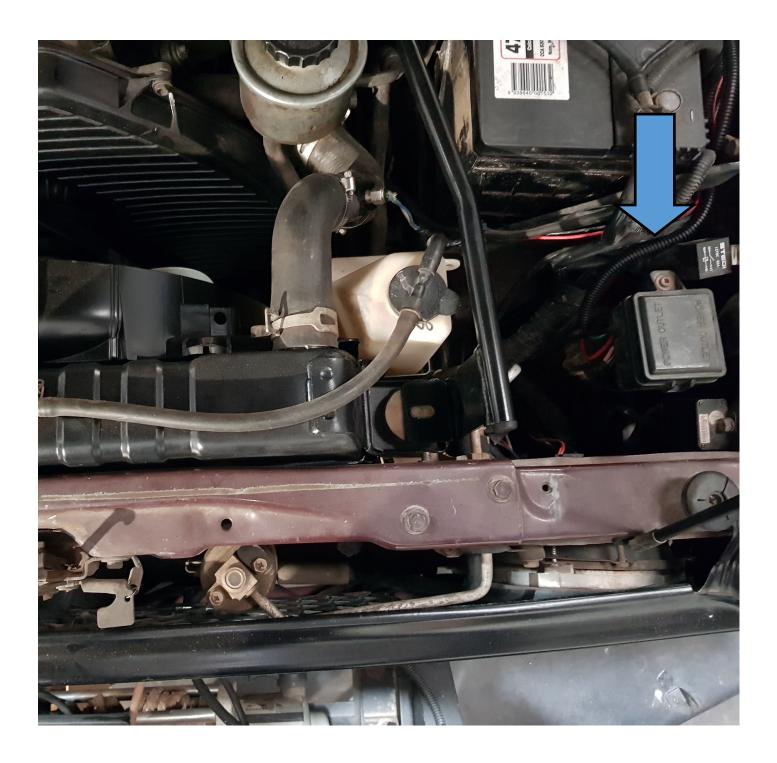
PLACE SUPPLIED FOAM SQUARES STICKY SIDE UP ON OUTSIDE EDGES OF INTER-COOLER AS SHOWN. CAREFULLY CLOSE BONNET DOWN SO THE FAOM SQUARES TRANSFER TO THE BONNET.
