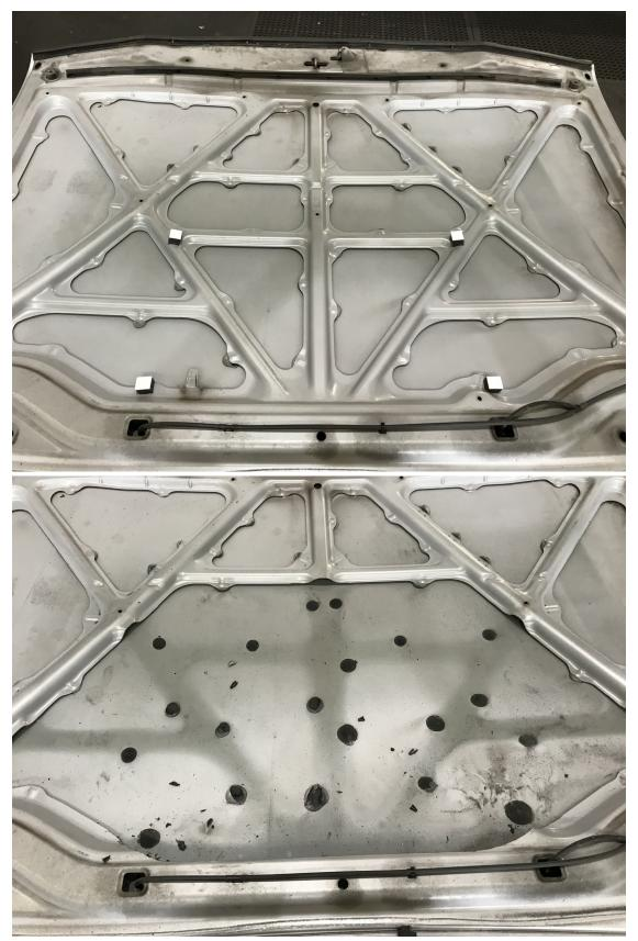
CUT OUT THE WEBBING AS SHOWN. REMOVE BONNET GLUE AND DEBURR ALL EDGES. READY FOR PAINT.
