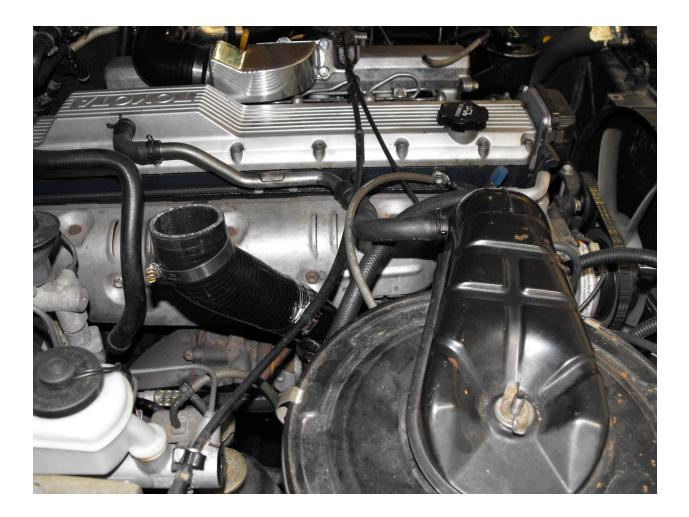
WITH INTERCOOLER FITTED INSTALL THE WIRING LOOM FOR THE FAN. WE RECOMMED RUNNING THE FAN WHEN THE IGNITION IS ON. A GOOD PLACE TO PICK UP IGNITION IS THE WIPER MOTOR.
