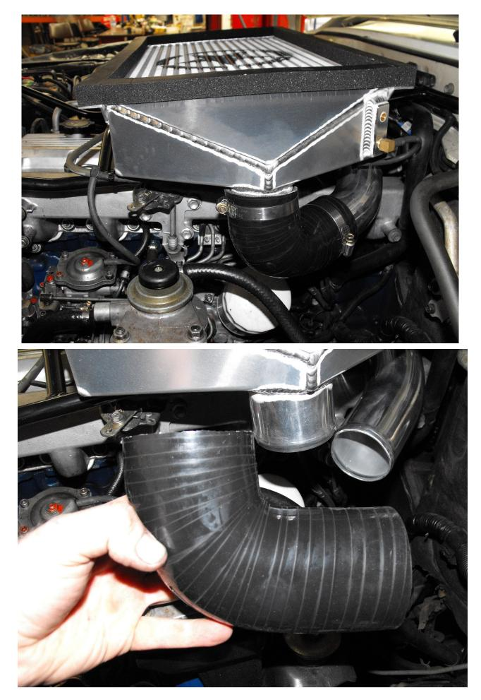
WITH THE INTERCOOLER FITTED TRIM THE 2 SILICONES ON THE TURBO SIDE TO FIT, ONCE CUT ASSEMBLE WITH ALLUMINIUM JOINER
