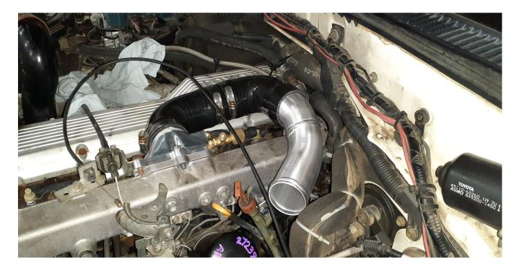
INSTALL SILICONES AND ALI PIPE AS SHOWN. THE REAR SILICONE MAY NEED TO BE TRIMMED FOR CLEAR-ANCE. TIGHTEN HOSE CLAMPS SHOWN. LEAVE OTHERS LOOSE FOR NOW.
