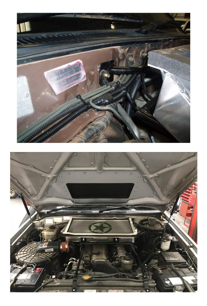
WITH THE INTERCOOLER FITTED TRIM SILICONE SHOWN AND FIT. TIGHTEN REMAINING HOSE CLAMPS.
